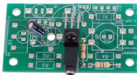
Module récepteur infrarouge Réf. K-AP-MRIR-M
