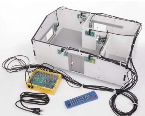
La maquette expérimentale complète, Présentée avec le boîtier de commande AutoProg et les cordons de liaisons.
