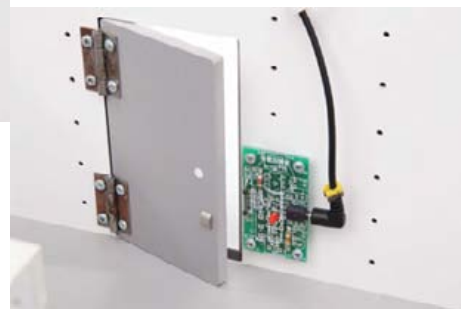
La porte et les deux fenêtres sont protégées par des modules ILS.
