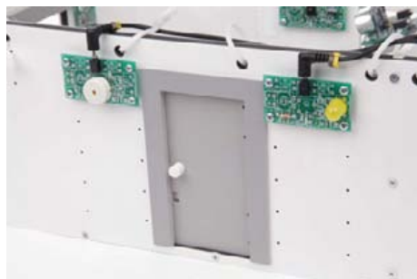
Les modules Buzzer et signal lumineux permettent de signaler toute intrusion.
